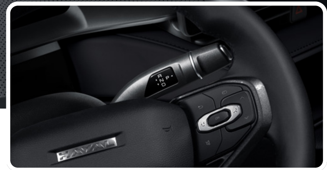
Automática de doble embrague (DCT) de 9 velocidades
